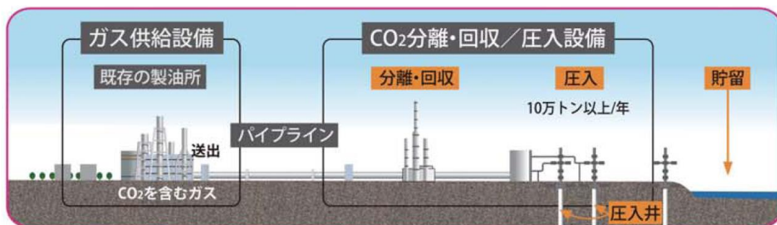
図 3.9 CCS 実証試験概要図
