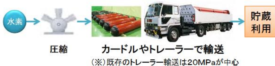
図 3.17 高圧ガスによる水素の輸送・貯蔵
