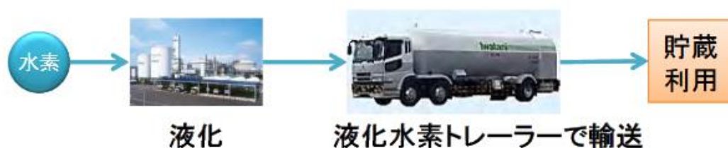
図 3.18 液化水素による水素の輸送・貯蔵
