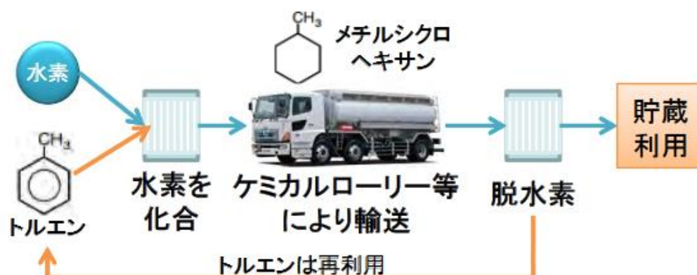
図 3.19 有機ハイドライドによる水素の輸送・貯蔵
